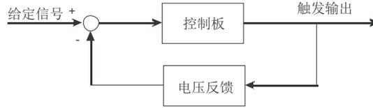
7.2、闭环恒流方式：在负载电压小于电压限制参数时，控制板的微处理器将电流反馈信号和给定信号比较，当电流反馈信号小于给定信号时，微处理器将增加输出直到电流反馈信号与给定信号相等，当电流反馈信号大于给定信号时，微处理器将减小输出直到电流反馈信号与给定信号相等。这种调节方式只要输入信号不变，即使电源电压变化或负载阻抗发生变化负载电流始终维持不变（不包括电网和负载阻抗瞬间突变），**具有电压限制功能，电压限制具有优先权**。示意图如下：
