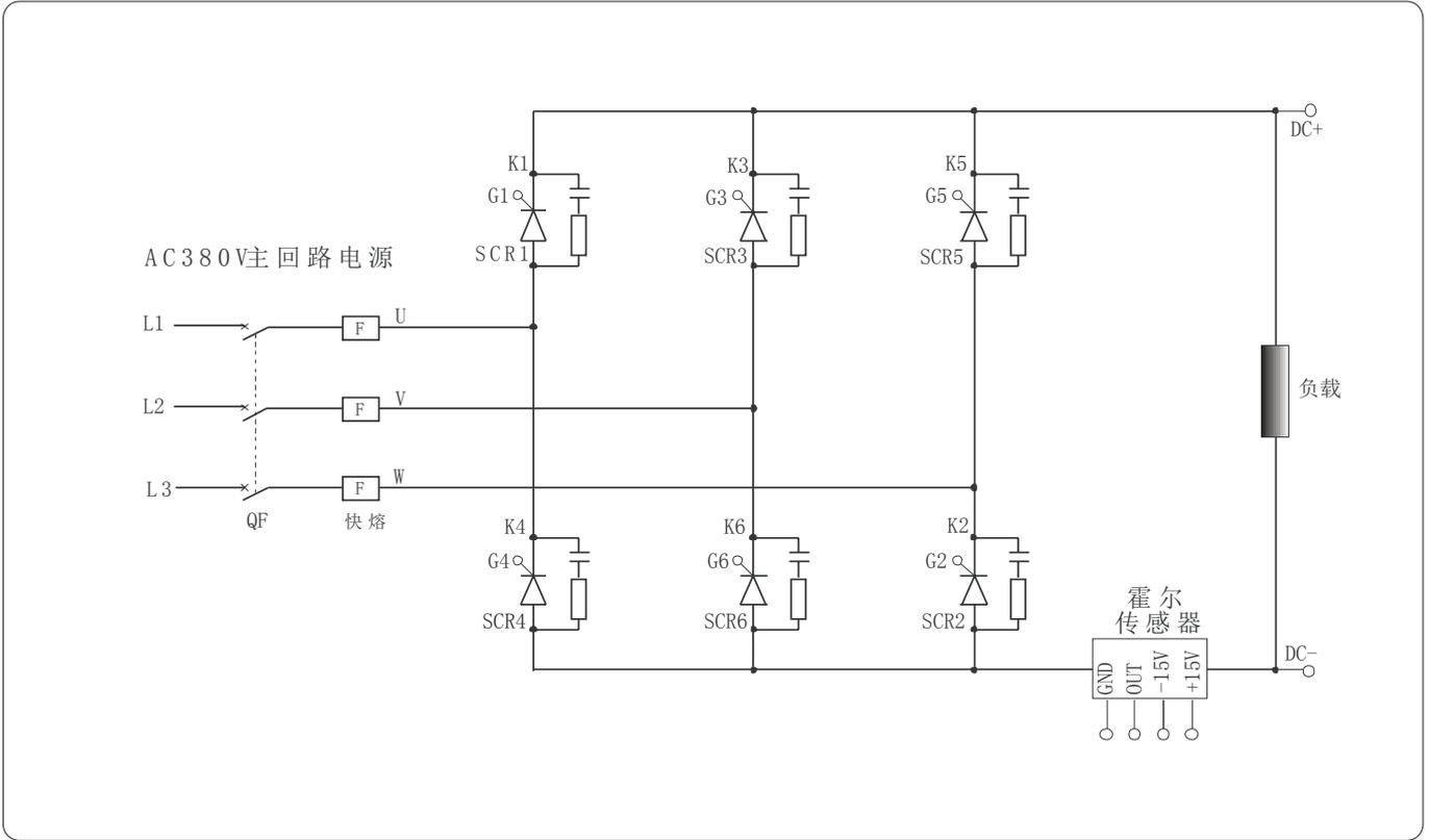
反馈隔离型变压全控整流接线(△/Y变压器, 此时需根据变压器的初次级相位差来调节P参数, 经验值为-30或30)：
