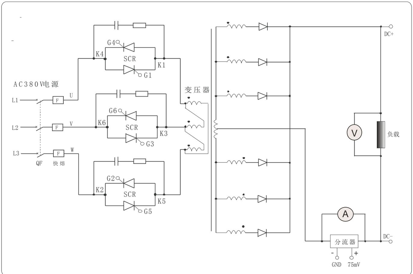
反馈隔离型带平衡电抗器的双反星型整流接线（此时需根据变压器的初次级相位差来调节 $\rho$ 参数，经验值为-30或30）：
