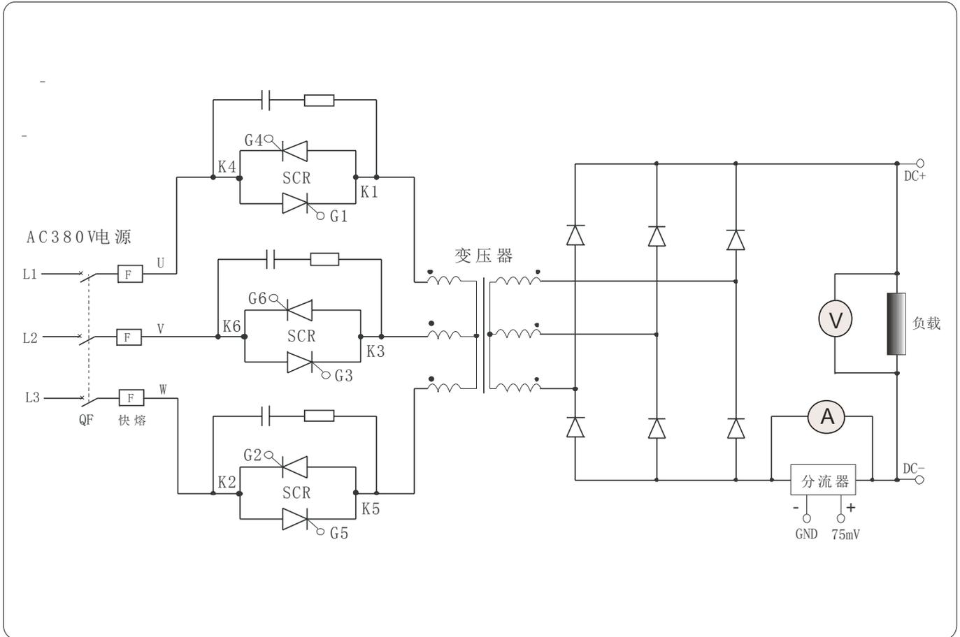
反馈隔离型半控桥式整流接线：
