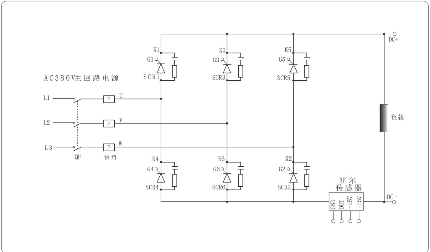
直流电机调速全控桥式整流接线：
