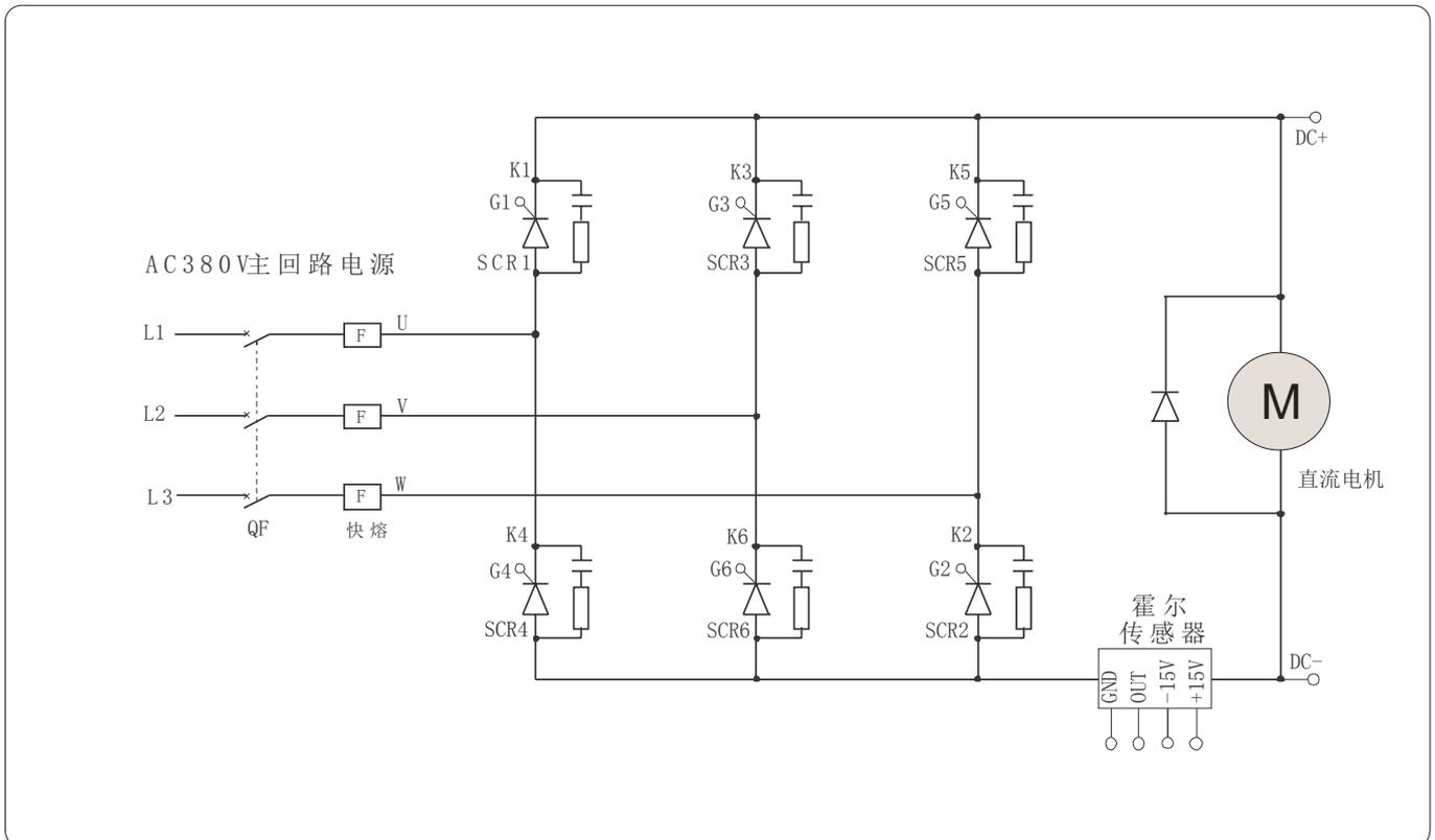
三相交流恒流恒压控制接线图：
