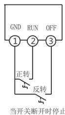
直流电正反转控制接线图：
