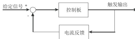
6.3、开环控制方式：控制板的微处理器将输入信号经过线性化后直接变换成可控硅导通角触发输出，在这种调节方式下电源电压或功率变化时控制板输出也随着变化，**具有限流、过压和过流保护功能**。示意图如下：
