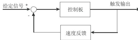
6.2、闭环恒流方式：在负载电压小于电压限制参数时，控制板的微处理器将电流反馈信号和给定信号比较，当电流反馈信号小于给定信号时，微处理器将增加输出直到电流反馈信号与给定信号相等，当电流反馈信号大于给定信号时，微处理器将减小输出直到电流反馈信号与给定信号相等。这种调节方式只要输入信号不变，即使电源电压变化或负载阻抗发生变化负载电流始终维持不变（不包括电网和负载阻抗瞬间突变），**具有电压限制功能，电压限制具有优先权**。示意图如下：
